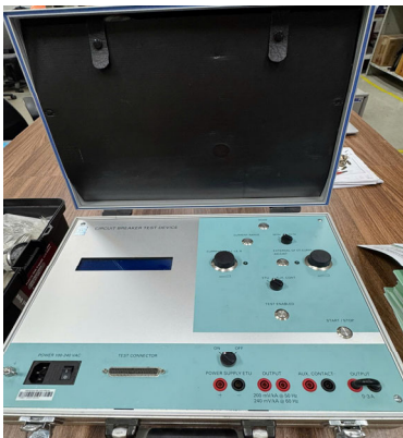
Thiết bị thử nghiệm máy cắt Siemens
