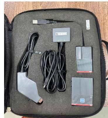
Thiết bị thử nghiệm máy cắt ABB
