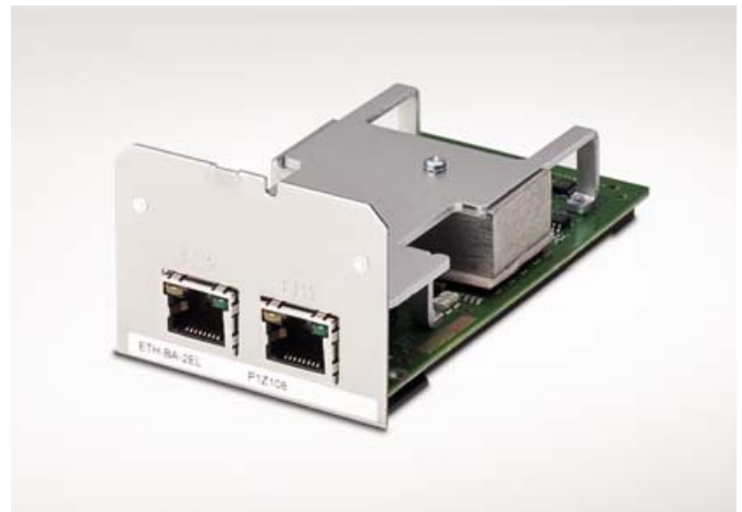
Fig. 6.6 Electrical Ethernet module (ETH-BA-2EL)
